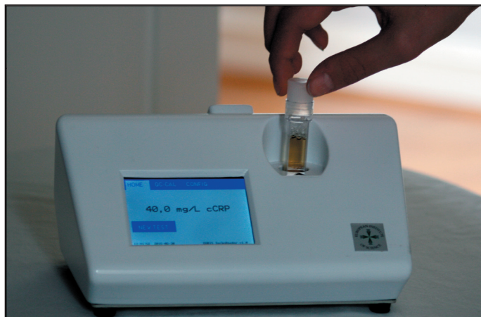
EURIS TurboReader™ veterinärt instrument för patientnära (POC) blodmätning av hund-CRP. Instrumentet erhölet EMC CE-godkännande enligt EN61326-1:2013 och EN61326-2-3:2013 vilket innebär att det uppfyller kraven på elektromagnetisk kompatibilitet (d v s att det inte kan störas av och inte blir störd av annan elektrisk utrustning) och att denna delkomponent i bolagets blodanalyssystem får säljas till kunder inom EU. Med instrumentet kan 15 stycken blodanalyser av bl a hund-CRP (inflammationsmarkör) göras per timme. Vid batteridrift kan instrumentet användas under en hel arbetsdag utan tillgång till nätspänning.
