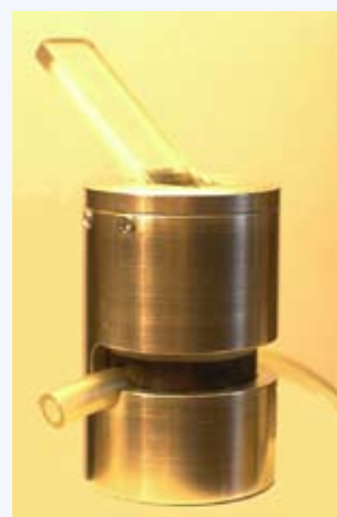
OBSQlip fästs direkt på blodslangen och levererar mätdata till dialysmaskinen.
